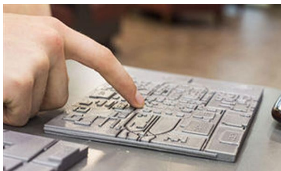
Εικόνα 8: Χάρτης εκτυπωμένος με τρισδιάστατη εκτύπωση στο Πανεπιστήμιο του Τέξας https://braceworks.ca/2016/08/10/health-tech/student-prints-3d-tactile-maps-of-campus-for-the-visually-impaired/
